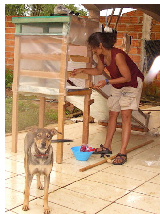
6. Montagem das prateleiras de secagem. A “porta” de acesso é simplesmente uma folha de plástico com um peso.
