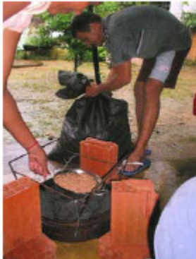
31. Um saco de lascas de madeira de mangueira é despejado na bacia.
