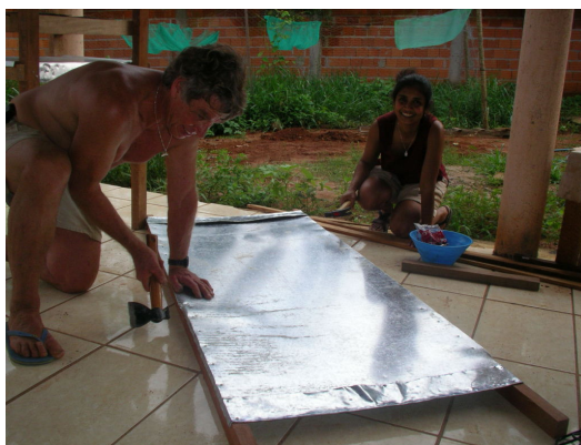
3. Fixando a folha de flandres na placa de fundo da câmara coletora de calor
