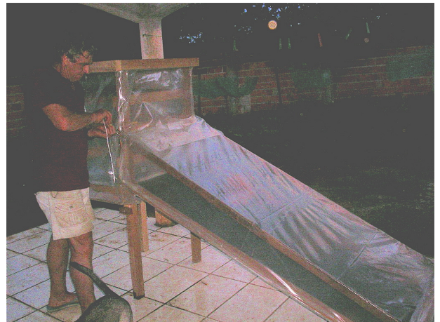
10. Apenas dois parafusos unem a câmara solar à estufa de secagem
