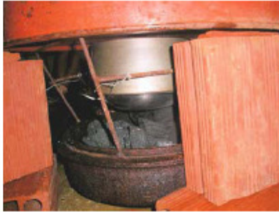
34. Uma tambor de freio de caminhão é usado para conter o carvão que irá produzir calor e fumaça.
